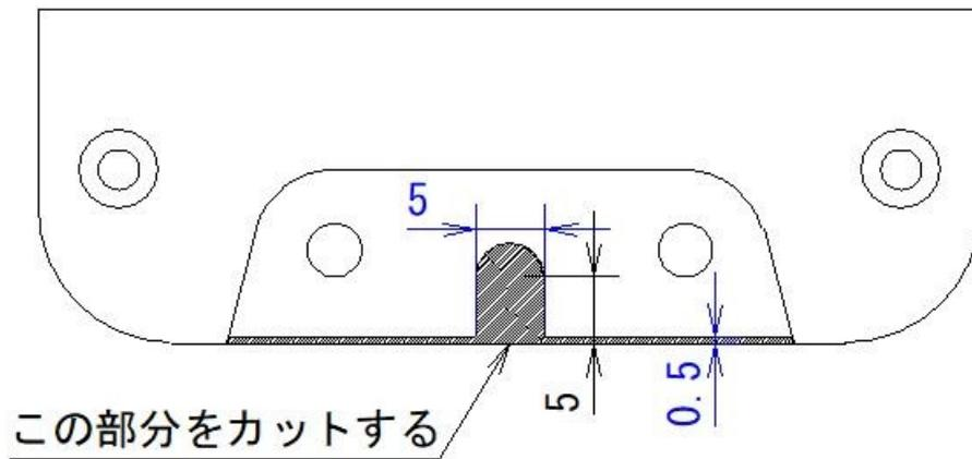
ロープロサーボマウント平置きタイプを使用時で
